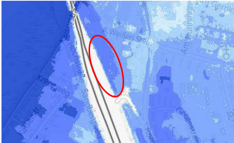
Abb. 11: Hochwassergefahrenkarten niedrige Wahrscheinlichkeit (HQ500) Quelle: ELWAS-WEB, MKULNV
