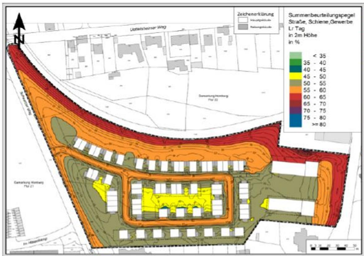
**Abbildung 7: Anlage I aus dem Schallschutzgutachten mit Darstellung der Summenbeurteilungspegel Straße, Schiene, Gewerbe unter Berücksichtigung einer beispielhaften Planbebauung, Immissionshöhe 2 m, tags**
